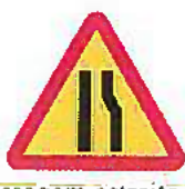
AT9- Passagem estreita esquerda
