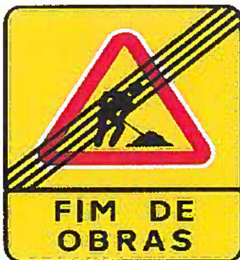
TV1 – Fim de trabalhos Dim.= 1,30 m x 1,30 m
